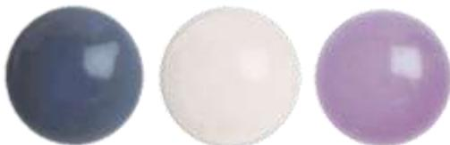
Verunreinigungen vor und nach der Reinigung. Links: mit blauem Farbstoff sichtbar gemachte Verunreinigungen. Rechts: Mit üblichem Handelsprodukt gereinigte Linse. Mitte: Mit Lösung „Reinigen R“ behandelte Linse<sup>1</sup>.
